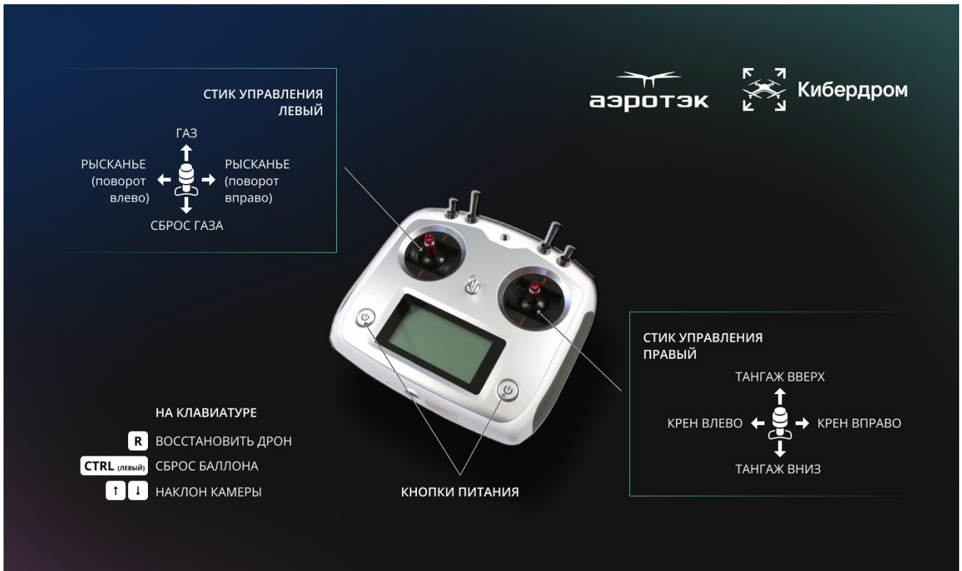
Рисунок 17 – Схема управления БВС в симуляторе с использованием пульта Полет БВС в симуляторе АЭРОСИМ выполняется в режиме ACRO с функцией GodMode («бессмертие»).
